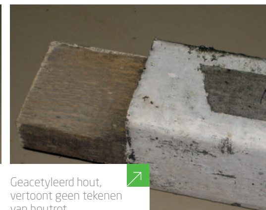
Niet geacetyleerd hout, vertoont tekenen van een grootschalige aantasting
