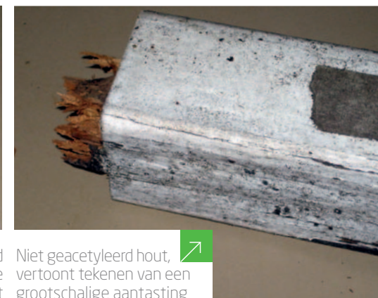
Niet geacetyleerd hout, vertoont tekenen van houtrot
